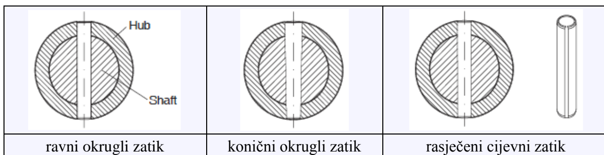
Slika 10.33 Rastavljivi oblikovni spoj sa zaticom [Childs 2004, 99]
